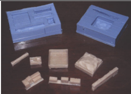
Einteilige Formen mit den selbst gegossenen Teilen
